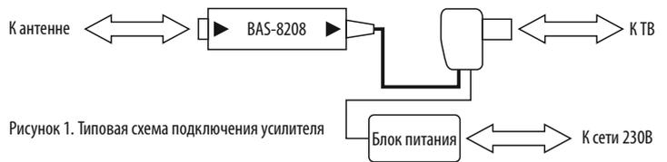
Рисунок 1. Типовая схема подключения усилителя
