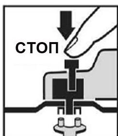
Для установки диска полностью нажмите кнопку блокировки шпинделя и непрерывно удерживайте ее в таком положении. При необходимости свободной рукой слегка поворачивайте шпиндель, пока он не будет заблокирован на месте.
